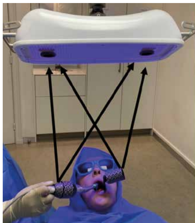
Fig 1 : Triangulation entre les deux caméras du X-Guide et les trackers QR positionnés sur le patient et sur le contre-angle.
